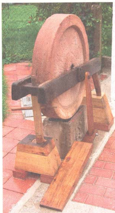
Neu in der Welz-Sammlung ist dieser Schleifstein. Das Besondere daran ist, dass er mittels eines versenkbaren Trogs gekühlt wurde. Foto: Manuela Rieger
